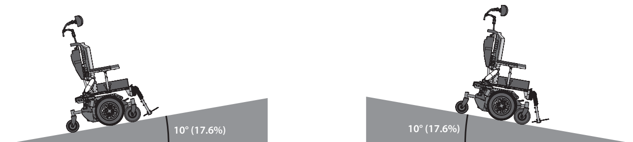
Figure 3. Ne pas circuler sur une pente dont l'inclinaison est supérieure à 10°.
