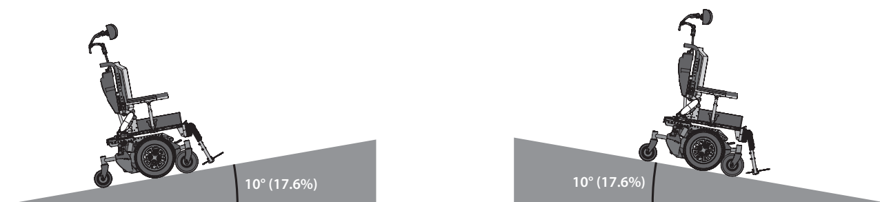
Figure 3. Ne pas circuler sur une pente dont l'inclinaison est supérieure à 10°.
