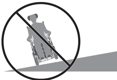
Figure 4. Ne pas tourner dans une pente.
