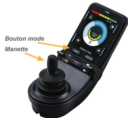
Cette manette est munie d'un module Bluetooth. Pour tous les détails d'utilisation et d'appairage, veuillez lire le guide abrégé du document fourni avec le présent manuel ou consulter le manuel technique R-Net CJSM2 en ligne sur notre site Web.
