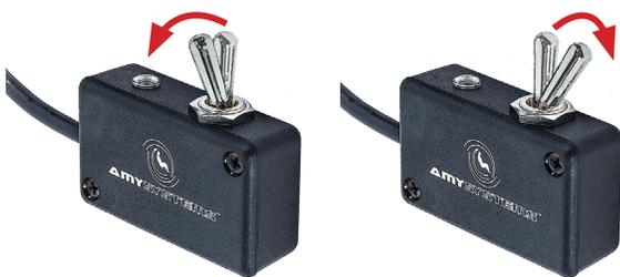
Pour activer l'option motorisée du siège, faire incliner l'interrupteur vers l'arrière et le maintenir ainsi jusqu'à ce que la position désirée soit atteinte, puis relâcher. Pour revenir à la position neutre, incliner vers l'avant et maintenir l'inclinaison.
