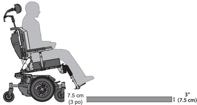
**Figure 2.** Ne jamais essayer de monter des obstacles supérieurs à 50mm (2 po) avec des roues avant de 150 mm (6 po). Par contre, il est possible de monter un obstacle de 75mm (3 po), avec les roues avant de 205 mm (8 po)
