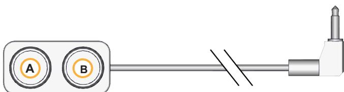
Pour activer l'option motorisée du siège, appuyer une fois sur le bouton (A) le plus éloigné du câble et maintenir l'appui jusqu'à ce que la position désirée soit atteinte, puis relâcher. Pour revenir à la position neutre, appuyer sur l'autre bouton (B) et maintenir l'appui.
